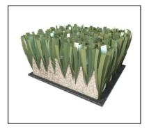
Césped artificial de última generación para la práctica del FUTBOL 5 y MULTISPORT, fabricado mediante sistema TUFTING, en una máquina del mismo nombre y de una medida de galga 5/16" con 17 Punt/dm, resultando 21.250 Punt/m².
